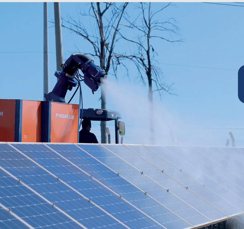
Realize a limpeza de seus painéis de solo, por aspersão de jato controlado de ar e utilizando somente 1,2 litros de água por módulo, evitando danos e preservando a garantia dos módulos.
